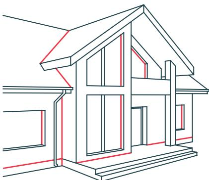
**FOME FLEX HYBRID ROOF&FAÇADE** skirtas sandarinti konstrukcines ir išsiplečiančias siūles fasaduose, stoguose bei siūles pėsčiųjų takuose ant dažniausiai naudojamų statybinių medžiagų, tokiai kaip betonas, plytų mūras, dažta mediena, emalis, alumininis, nerūdijantis plienas ir įvairūs plastikai.
